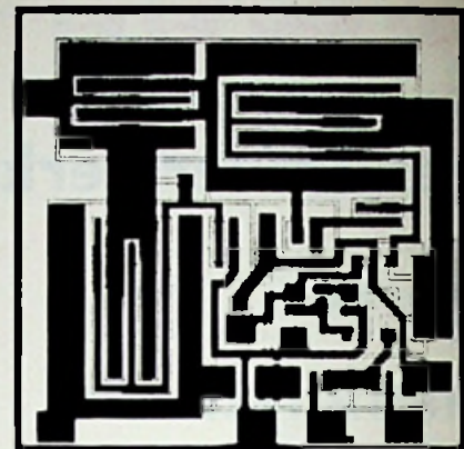
Fig. 3. Geometrie van de monolithische componenten en verbindingen (PA237).
